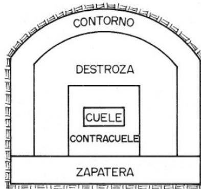
Figura 26: Esquema de voladura. Fuente:[13]
