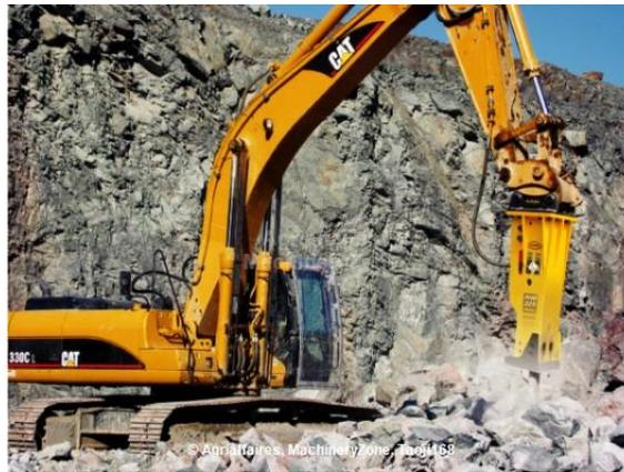
Figura 31: Máquina excavadora con martillo hidráulico. Fuente[R]
