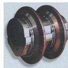
Figura 34: Detalle de un disco cortador. Fuente: [W]
